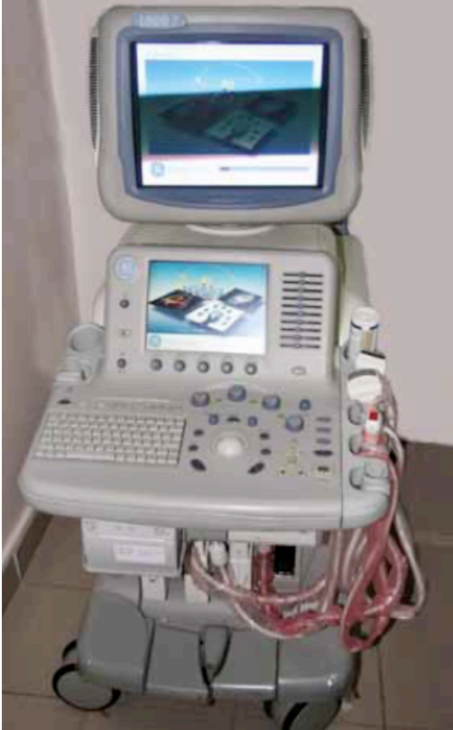
Şekil 4: Ultrasonografi cihazı (GE LOGIQ 7).
